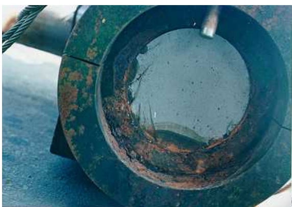
Fig. 2 - Sección del Vástago Roto
